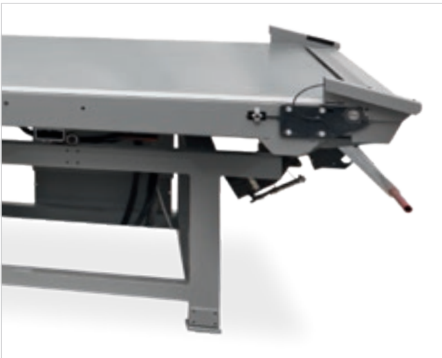
Am Ende des Bands positioniertes Saugrohr.
