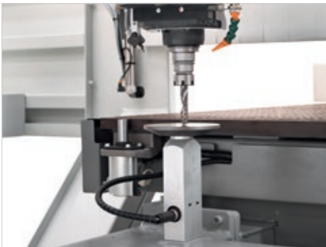
Der Tast-Teller ermöglicht es, die Messung der Werkzeuglänge bis 130 mm Durchmesser automatisch durchzuführen. Dadurch können die Zeiten für die Maschinenbestückung erheblich reduziert und die Möglichkeit von Bedienerfehlern ausgeschlossen werden.
